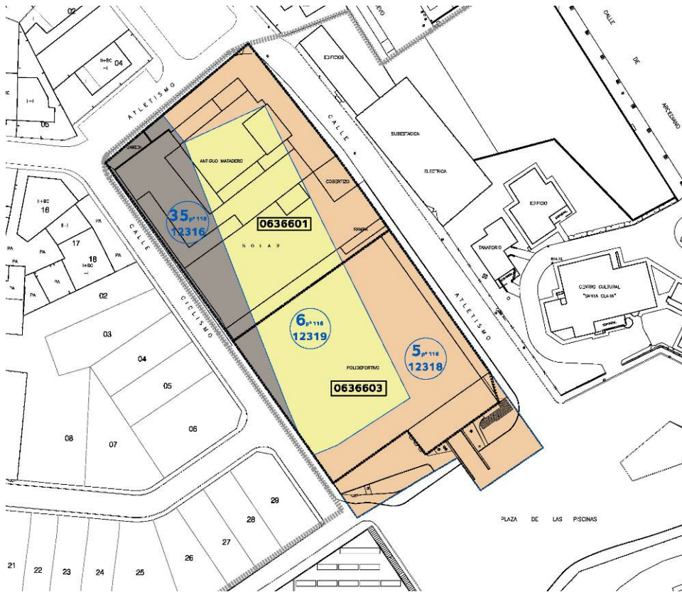
2. Esquema de superposición sobre el levantamiento topográfico de la cartografía catastral actual y antigua.
